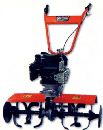
Мотокультиватор ROBI-156, сделан в Венгрии, мощность 5 л.с.
